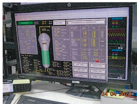
ภาพที่ 2-19 ระบบตรวจวัดค่าอุณหภูมิ และความดันในถังปฏิกรณ์
